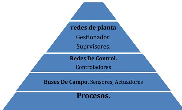
Figura 6. Comunicación de un sistema automatizado (Fuente propia).
