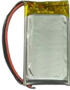
Figura 30. Batería lipo 300mAh (Propia autoría).
