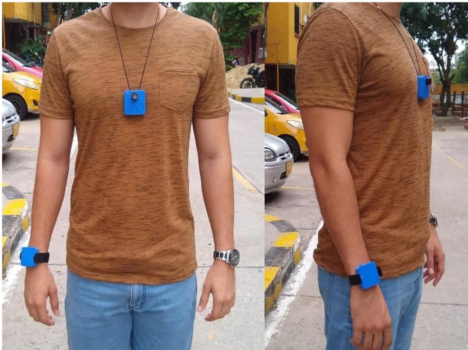
Figura 11. Disposición de los dispositivos vista frontal y lateral (Propia autoría).
