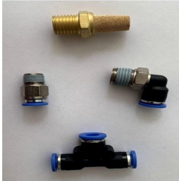
Figura 23. Racores y Silenciador cónico en Bronce. (propia autoría).
