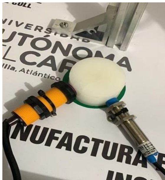
Figura 59. Prueba de sensor réflex para pieza de polipropileno. (propia autoría).
