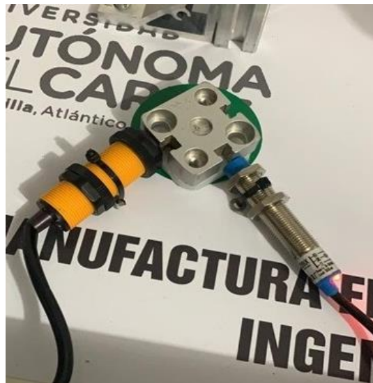
Figura 57. Prueba de sensor inductivo para detección material metálico. (propia autoría).
