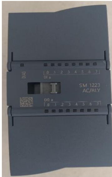
Figura 4. Modulo extensión S7-1200 (propia autoría).
