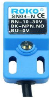
Figura 34. Sensor inductivo de posición home. (Fuente propia).
