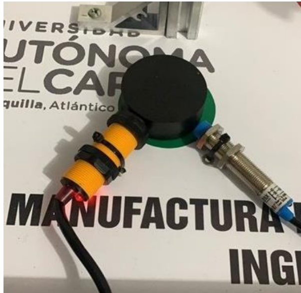
Figura 58. Prueba de sensor réflex para detección material Empack. (propia autoría).
