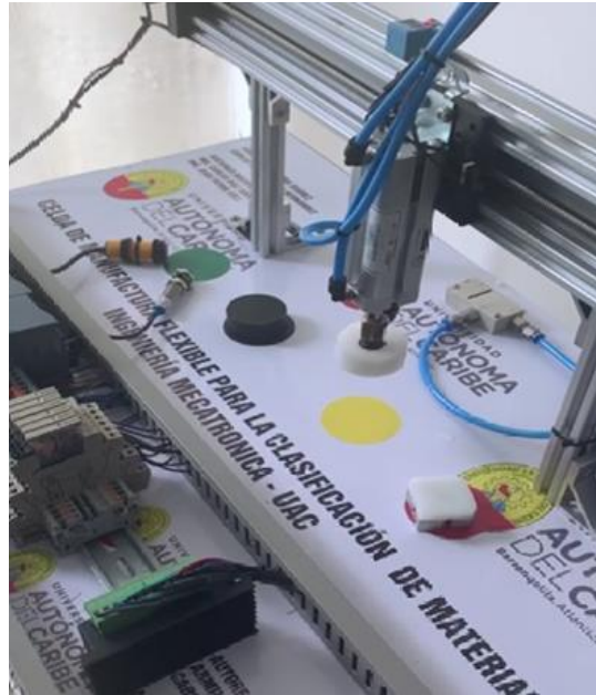
Figura 65. Clasificación de material polipropileno. (propia autoría).
