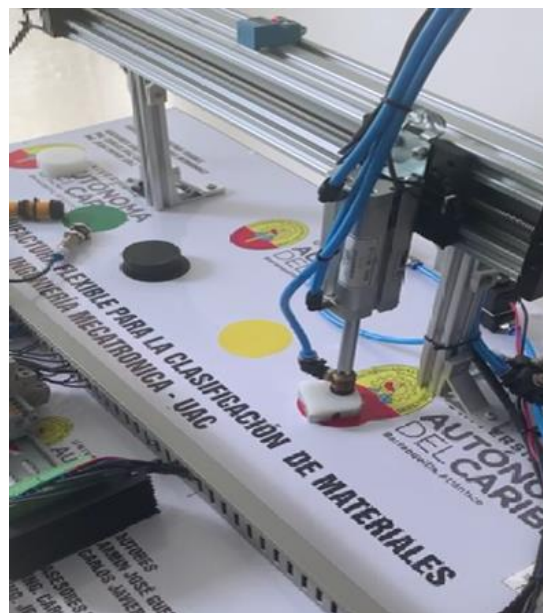
Figura 64. Clasificación del material metálico. (propia autoría).
