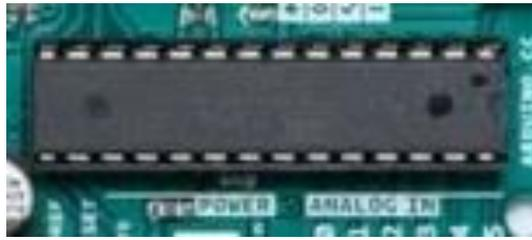
**Figura 55. Microcontrolador ATmega.**
