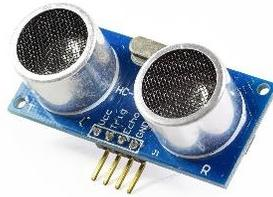
**Figura 62. Sensor ultrasonido HC-SR04.**
