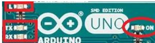
**Figura 53. Led de encendido y TX – RX.**
