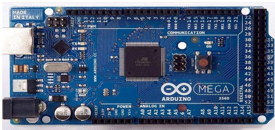
Figura 47. Placa Arduino MEGA (hardware) [32].
