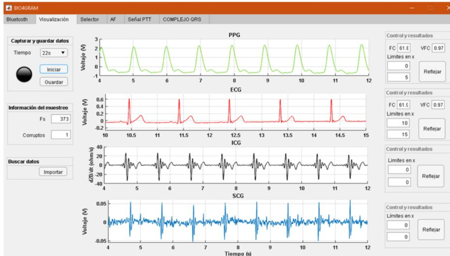
Cada grafica (PPG, ECG, ICG y SCG) tendrá su propio panel de “Control y resultados”, para las dos primeras, la aplicación presentara en pantalla, la frecuencia cardíaca y su variabilidad. Por otro lado, en cada una, será posible modificar los límites en x, el contenedor numérico superior corresponde al límite izquierdo y el contenedor inferior, corresponde al limite derecho en la grafica, luego de escribir los límites, solo es necesario dar clic en “reflejar”.
