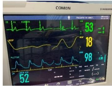
Se utilizó la ecuación 19, en la tercera prueba según los datos de la figura 63, la frecuencia cardíaca promedio da como resultado 53.6 latidos por minutos y para el BIO4GRAM, fue de 53.77 y 54.43, en PPG y ECG respectivamente, en este caso, el porcentaje de error fue por encima del 1%.
