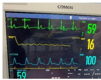
Se utilizó la ecuación 19, en la segunda prueba según las capturas de la Figura 61, la frecuencia cardiaca promedio da como resultado una 64.2 latidos por minutos y para el BIO4GRAM, se obtuvo una salida de 63.59 y 64.02, en PPG y ECG respectivamente, en este caso, el porcentaje de error fue menor a 1%.
