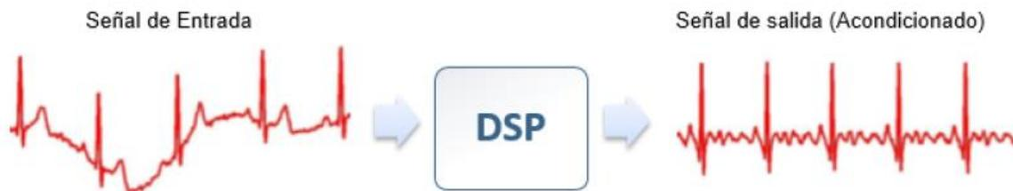
Con respecto a la señal ICG, también es necesario realizar un filtro FIR pasa banda, con frecuencias de corte 0.7Hz y 7Hz [47]. Luego, se aplica la función “*detrend*” [86] para centrar la onda en 0, con lo anterior, se resta la media o una línea mejor ajustada de los datos.
