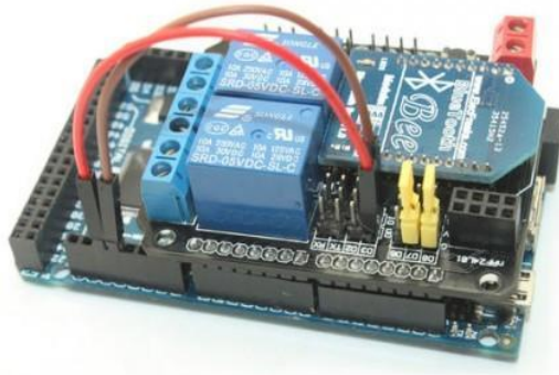
Figura 21. Armado Arduino con Shield 2ch Rele Xbee.
