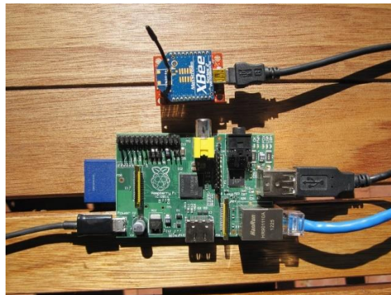
Figura 22. Armado Raspberry con Modulo Explorer y Xbee Coordinador.
