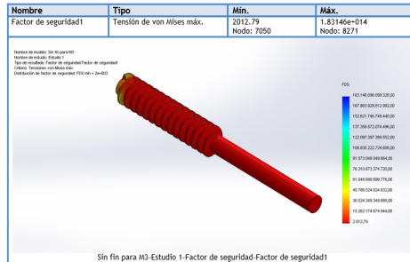
Figura 10. Resultado del estudio del factor de seguridad en el tornillo sin fin.
