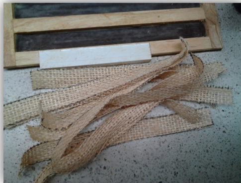
Figuras 13 y 14: Probetas de fique y molde para realizar el proceso de curado
