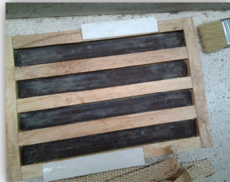
Figuras 13 y 14: Probetas de fique y molde para realizar el proceso de curado
