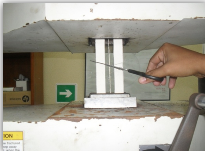
Figura 4: Ensayo de tensión a la fibra de fique
