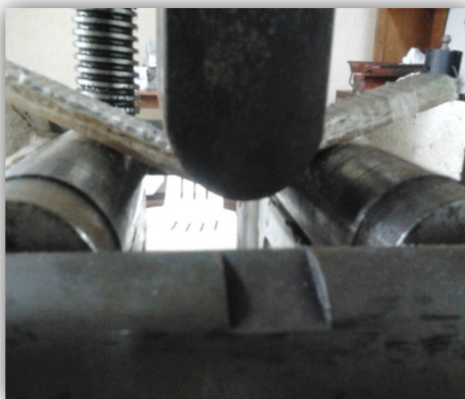
Figura 17: Probeta sometida al ensayo de flexión
