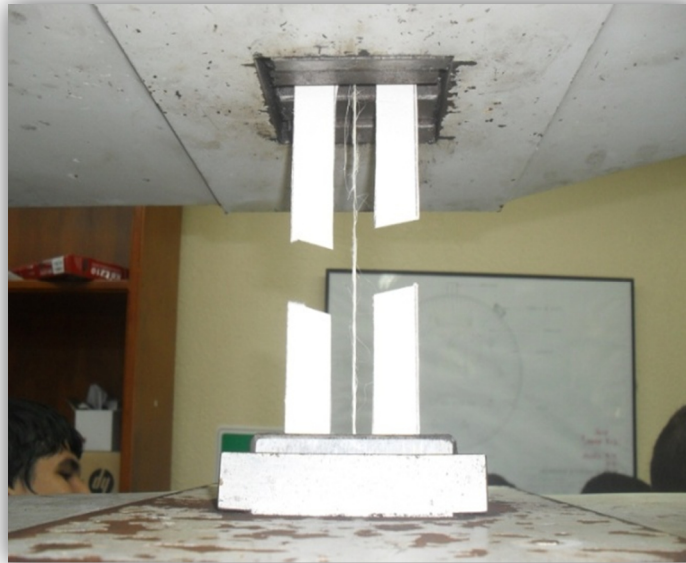
Figura 5: Ensayo de tensión a la fibra de fique
