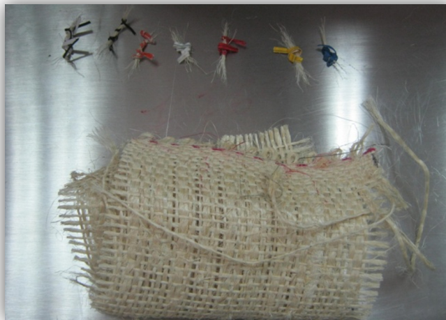
Figura 2: Medición del número de hilos en una hebra de fique
