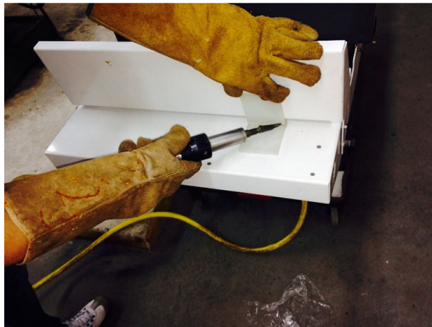
Figura 26 ensayo de soldadura en la Thermoforming centre 911
