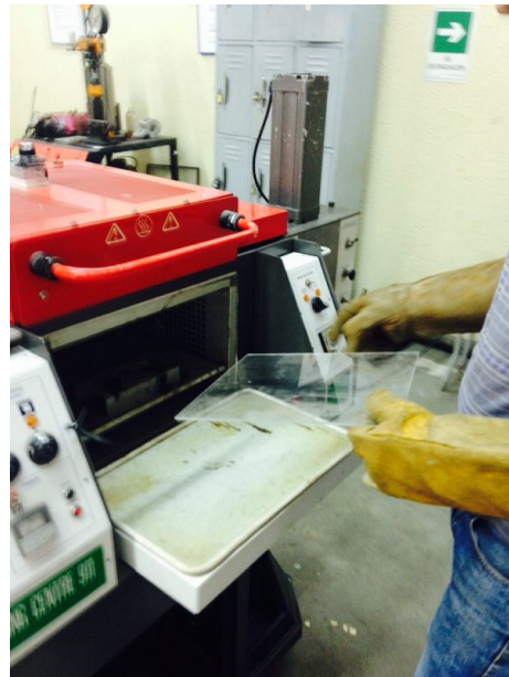
Figura 10 Calentamiento de la lámina en el horno para el domo formado
