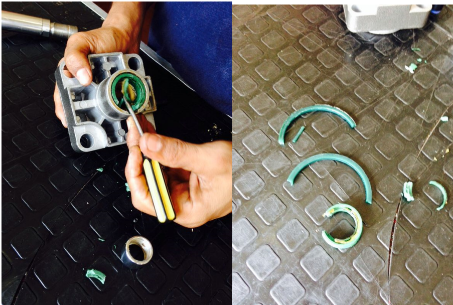
Imágenes tomadas por los autores en el cambio de empaques del cilindro
