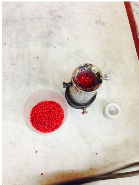
Imagen tomada por los autores cargando de plástico el crucible de la Termoformadora
