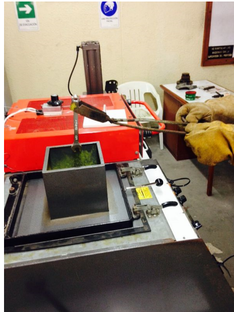
Figura 21 ensayo de recubrimiento plástico
