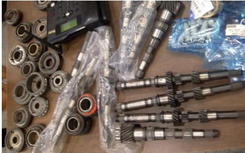
Figura 2. Componentes caja de velocidades Hyundai Atos.
