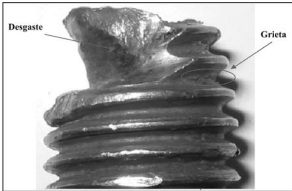
Figura 5 Acercamiento de la zona de desgaste.
