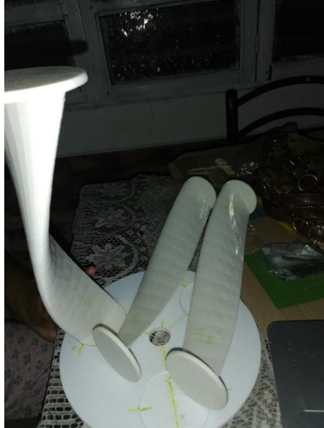
Fig 59. Alabes impresos en PLA y tapa maquinada en cnc. (fuente: autor)
