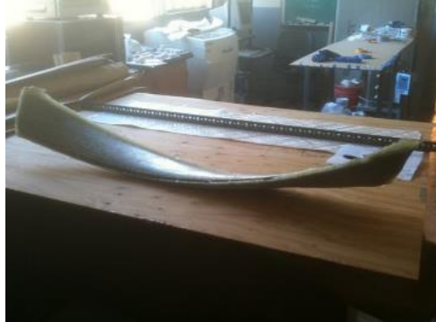
Figura 8. Fabricación de alabe con errores
