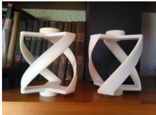
Figura 15. Modelos impresos antes de ser lijados. (120° izquierda y 90° derecha)
