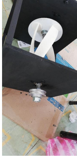
Fig 63. Montaje turbina en carcasa de soporte (Fuente: autor)
