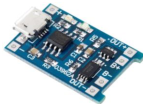
Figura 29. Módulo Cargador Batería de LiPo 1A Micro Usb 5V – TP4056.
