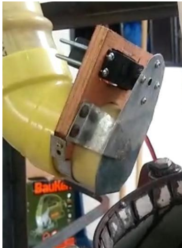
Figura 18. Compuerta silos. Propia autoría.
