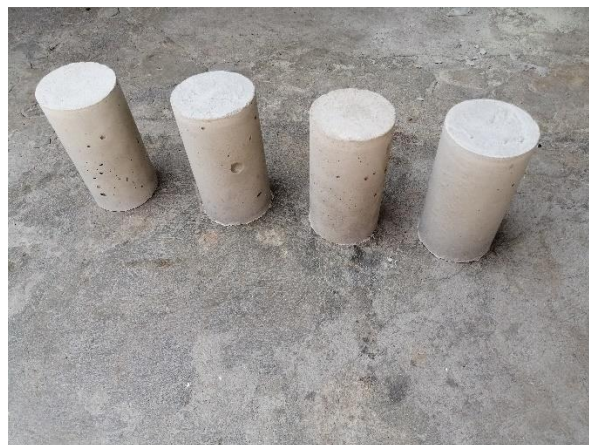
Figura 12. Probetas después de 28 días de secado. Propia autoría.
