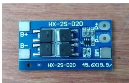
Figura 32 Modulo de carga de baterías
