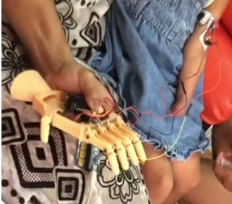
Figura 35. Prueba de apertura con la señal EMG de la paciente (autoría propia).
