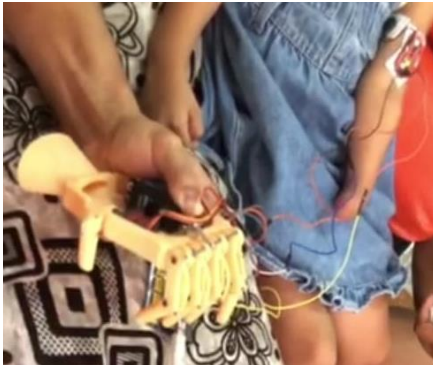
Figura 36. Prueba cierre con la señal EMG de la paciente (autoría propia).
