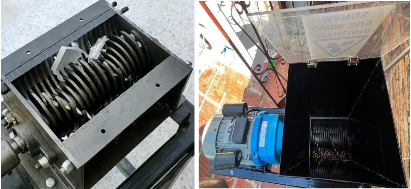
Figura 28. Sistema de cuchillas de máquina trituradora. Fuente: Propia del Autor
