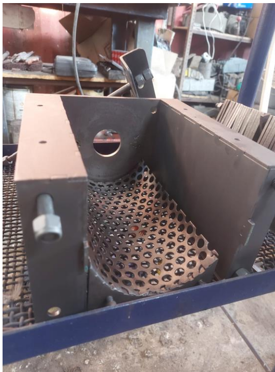
Figura 24. Ensamblado de la caja de trituración. Fuente: Propia del Autor
