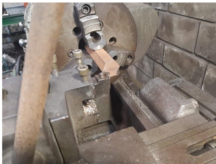
Mecanizado Varilla Hexagonal. Fuente: Propia del Autor.
