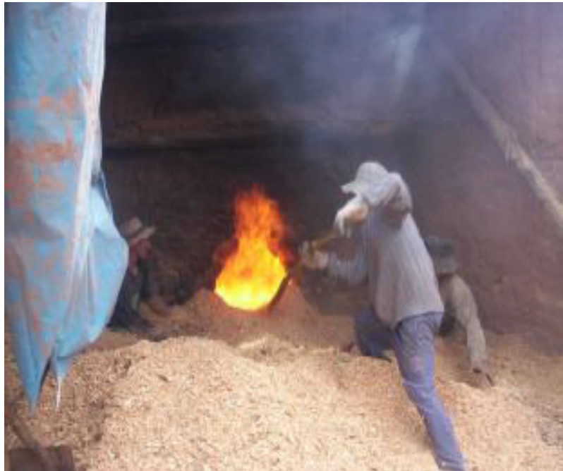
Figura 7. Hogar para quemado tradicional de combustible sólido tipo cascarilla de arroz.
