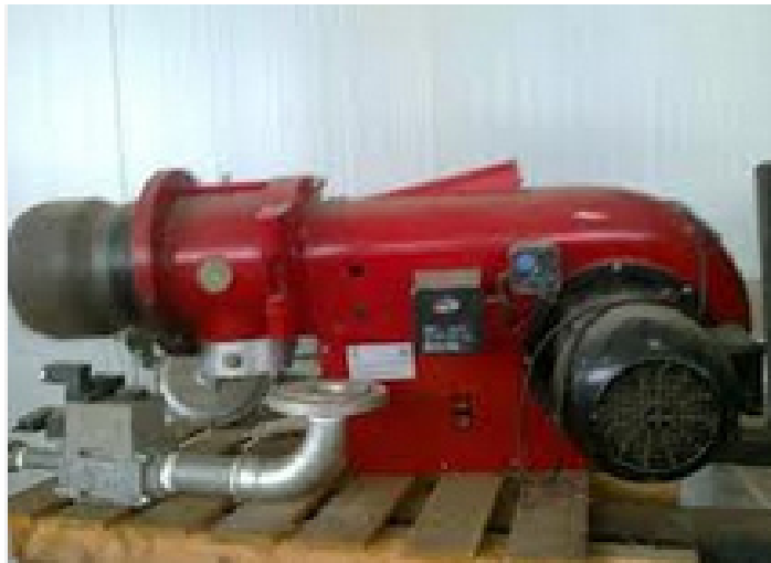
Figura 8. Equipo quemador de gas natural
