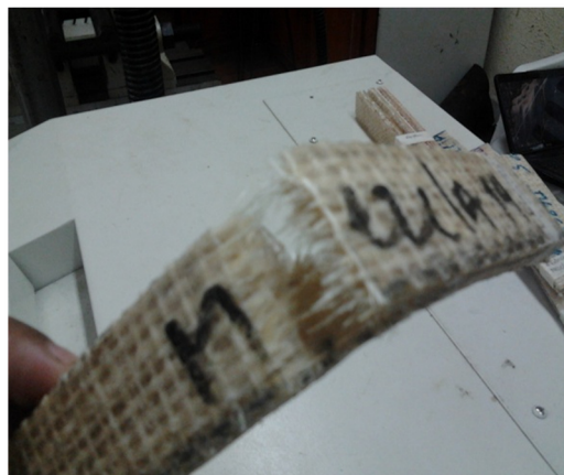
Figura 31: Probeta de la mezcla 1 con 3 capas de fibra
