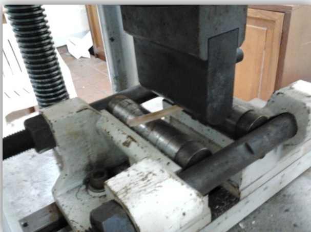
Figura 21: Probeta sometida a flexión a tres puntos
