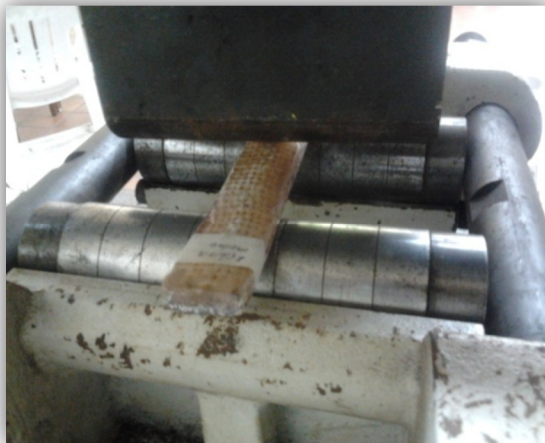
Figura 30: Ensayo de flexión al compuesto
