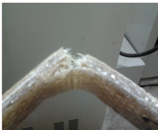
Figura 32: Probeta mezcla 1 con 3 capas de fibra
