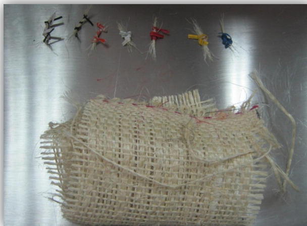
Figura 7 Medición del número de hilos en una hebra de fique
