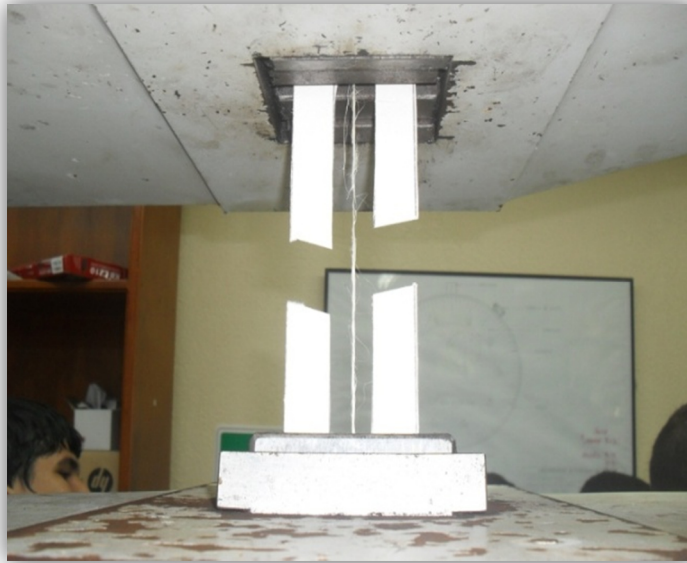
Figura 11: Fibra sometida al ensayo de tensión
