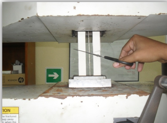
Figura 10: Corte del marco que sostiene la fibra
