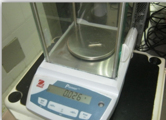
Figura 6: Medición de la masa de la fibra de fique
