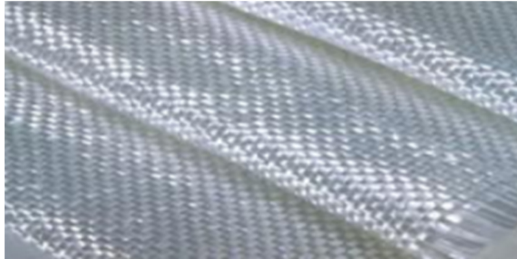
Figura 7. Fibra de vidrio tipo woven roving.
