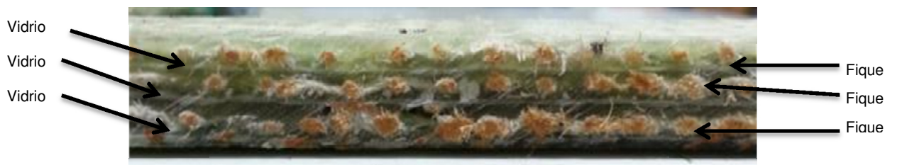
Figura 24. 3 capas de fibra fique, 3 capas de fibra de vidrio E (50/50)
