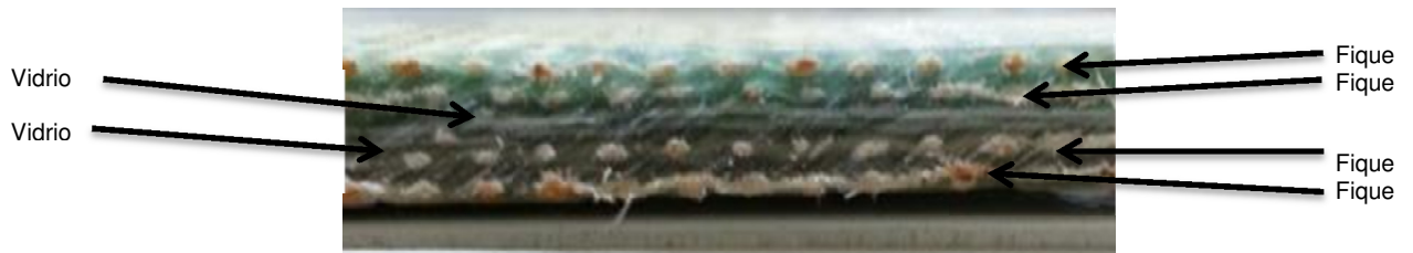
Figura 23. 4 capas de fibra fique , 2 capas de fibra de vidrio E (67/33)
