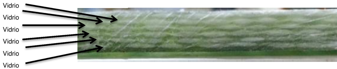
Figura 26. 6 capas de fibra de vidrio E (0/100)
