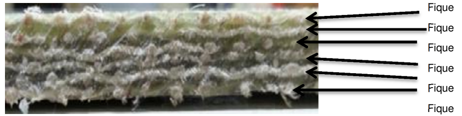
Figura 23. 4 capas de fibra fique , 2 capas de fibra de vidrio E (67/33)
