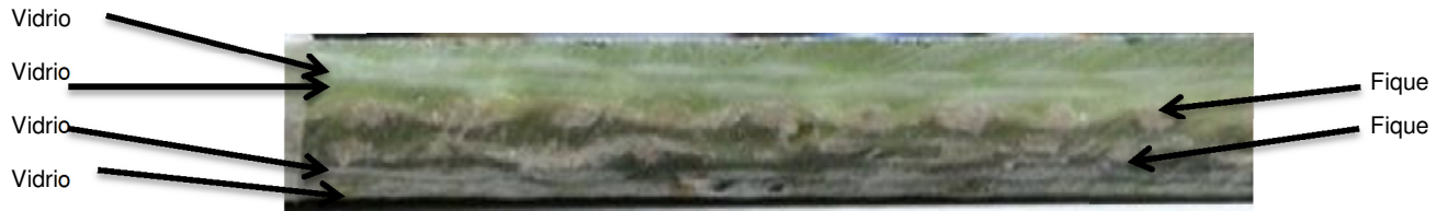
Figura 25. 2 capas de fibra fique, 4 capas de fibra de vidrio E (33/67)
