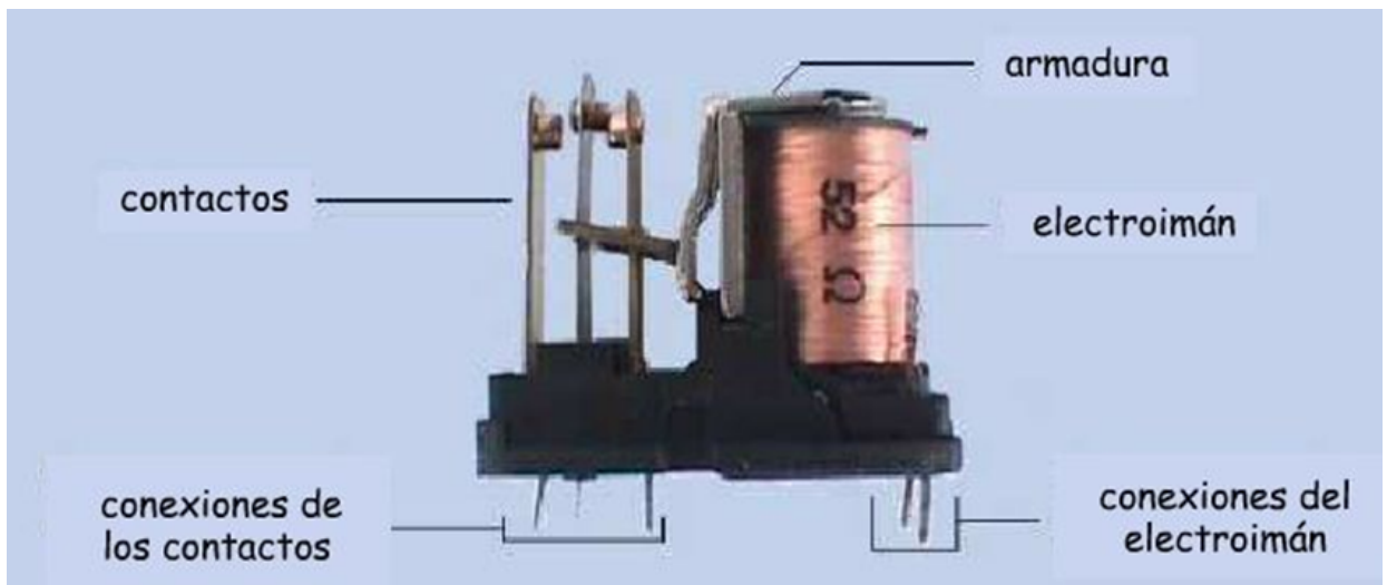
Figura 5. Partes de un relevador
