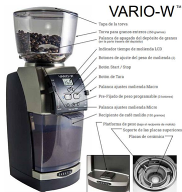
Figura 11. Molienda Automatiza. Tomada de manual de instrucciones del dispositivo
