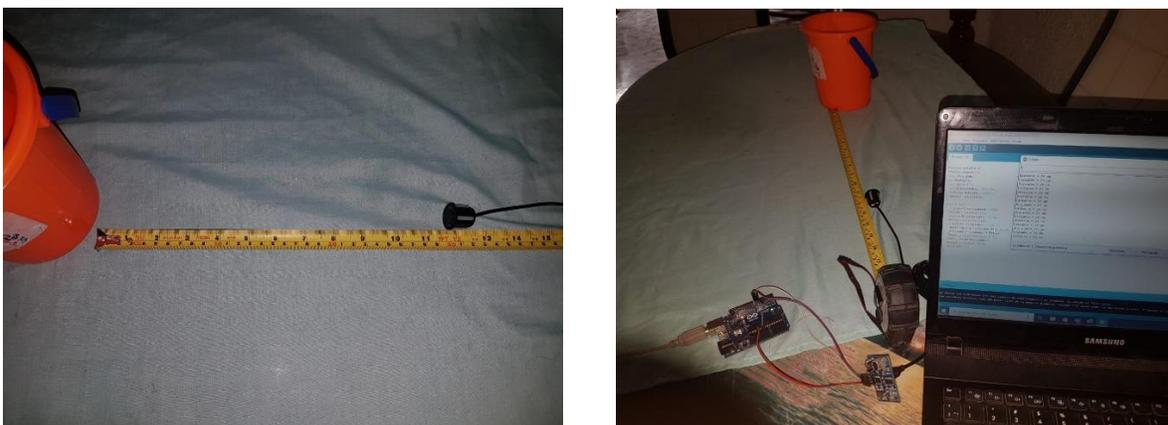
Figura 4 Caracterización sensor distancia
