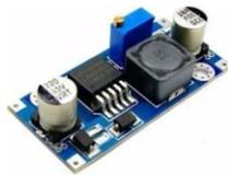
*Figura 35. Módulo lm2596 reductor de voltaje.*
