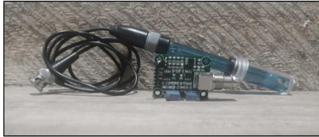
*Figura 18 Sensor de pH CrystalLiquid/Arduino Gen*
