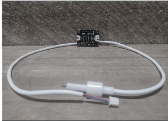
*Figura 20 Sensor de conductividad CrystallLiquid/Arduino Gen*
