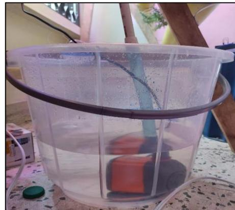
Figure 25 Contenedor con líquido hidropónico y su respectiva motobomba
