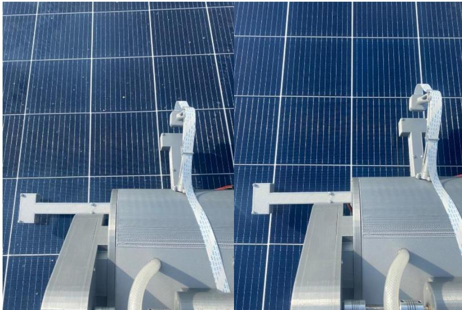
*Figura 32. a) Panel sucio, antes de la limpieza, b) panel limpio, después de la limpieza con el dispositivo*
