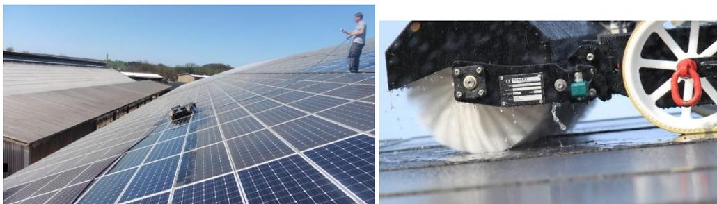
Figura 2. HyCleaner en acción con operarios sosteniendo la manguera de suministro de agua
