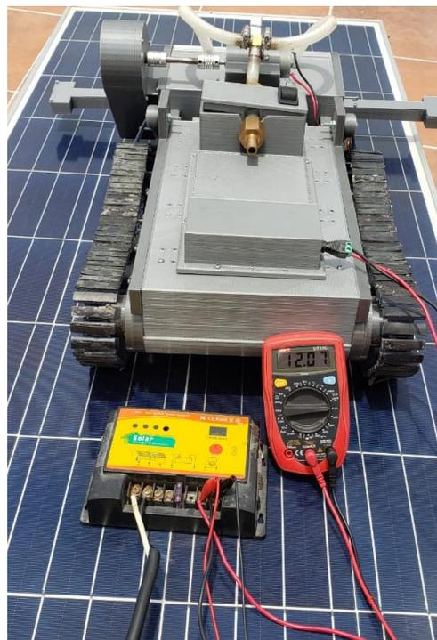
*Figura 18. Estación de carga*
