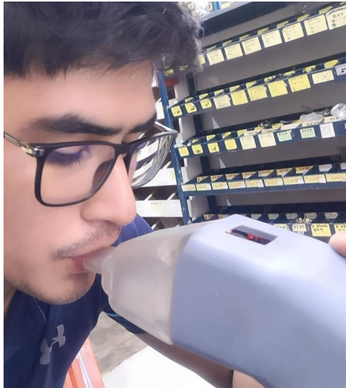
Ilustración 57 Prueba de alcohol con el sensor MQ3.
