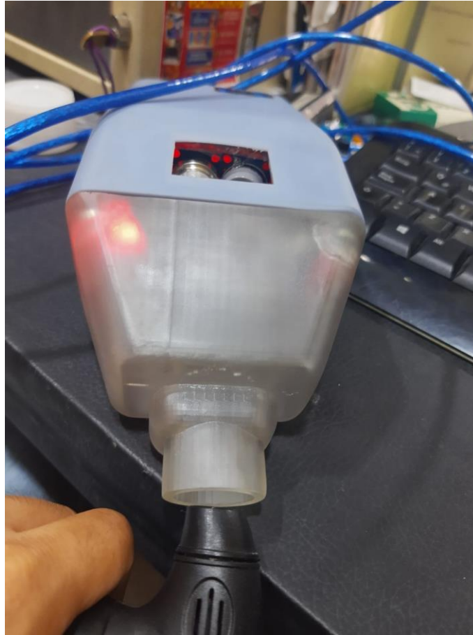
Ilustración 67 Prueba de metano con el sensor MQ4.
