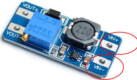
Figura 34 MT3608 conexión de entrada de voltaje (Propia autoría)
