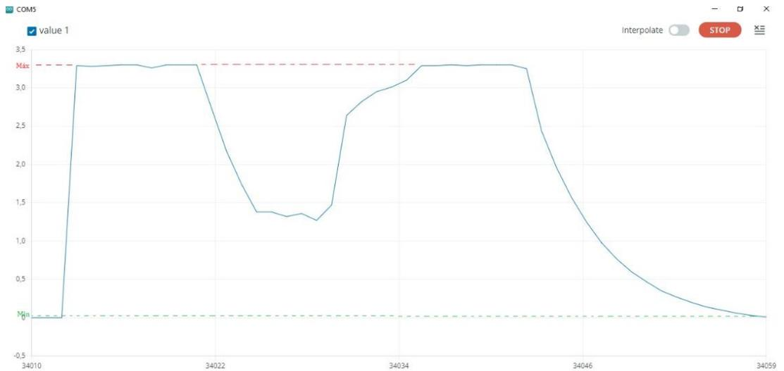
Figura 27. Adquisición de la señal electromiográfica (EMG) máxima y mínima obtenida por el sensor MyoWare, situado en el bíceps del joven. Fuente: Autoría propia.
