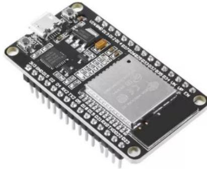
Figura 21. Microprocesador ESP32. Fuente: [41]
