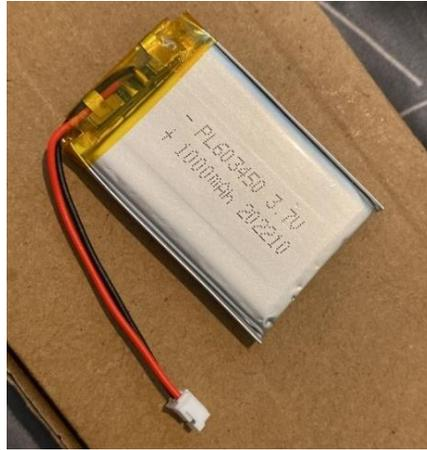
Figura 22. Batería de Litio 3,7V 1000mAh. Fuente: autoría propia
