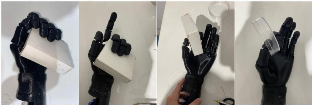
*Figura 39. Prueba de ángulo en servomotores. Fuente: autoría propia.*
