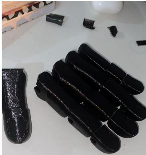
*Figura 33. Proceso de ensamblaje de los dedos de la prótesis. Fuente: autoría propia.*
