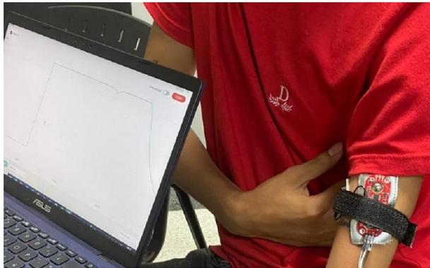
*Figura 42. Señal obtenida por medio de los electrodos contruidos en tela conductora. Fuente: autoría propia.*
