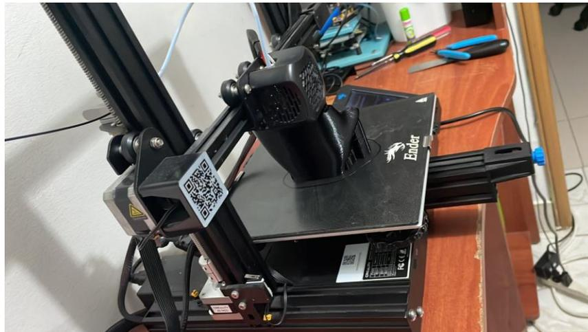
*Figura 29. Impresora 3D Ender-3 V2 realizando el proceso de impresión de la palma de la mano de la prótesis. Fuente: Autoría propia.*
