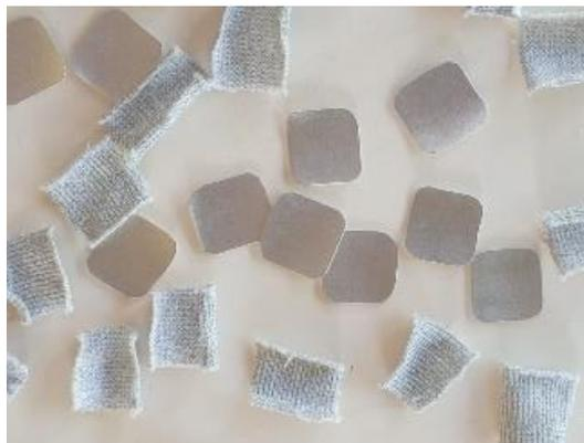
*Figura 30. Construcción de electrodos de tela conductiva. Fuente: autoría propia*
