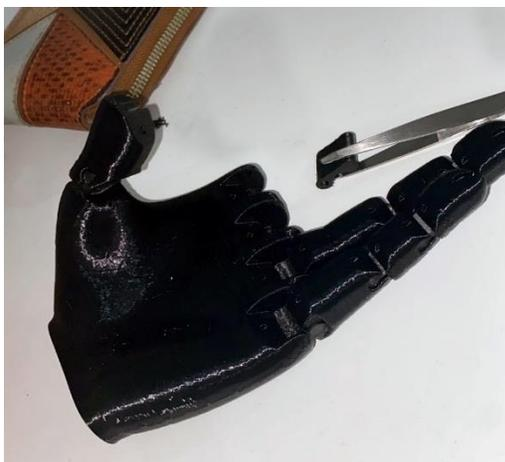
*Figura 34. Ensamblaje de los dedos a la palma de la mano impresa en 3D. Fuente: autoría propia.*
