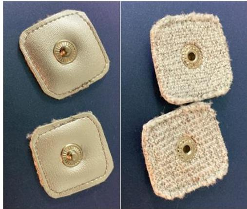
*Figura 31. Electrodo construido de tela conductiva. Fuente: autoría propia*
