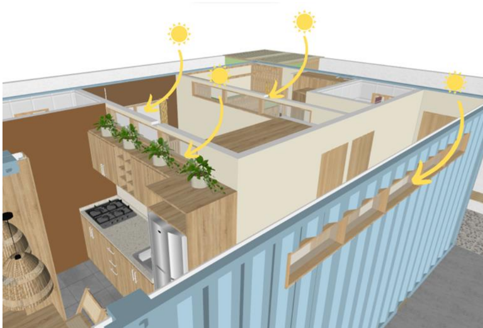
Ilustración 57: Iluminación natural por medio de ventanas
