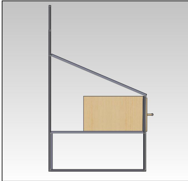
Figura 56. Vista lateral de la mesa de trabajo del banco de neumática.
