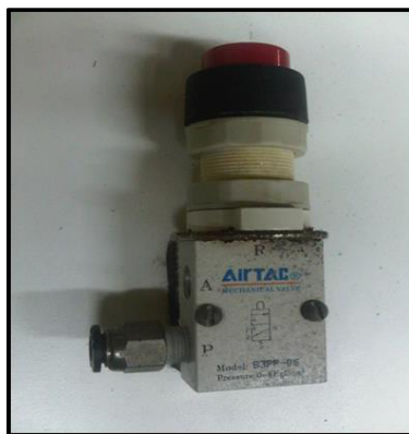
Imagen 12. Válvula 3/2 accionada por pulsador y retorno por muelle
