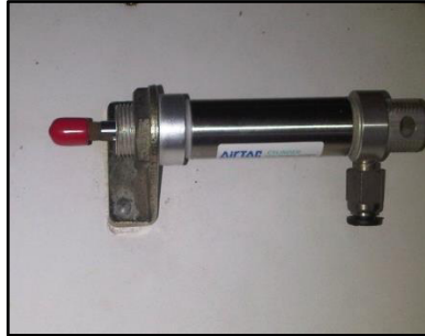
Imagen 25. Cilindro simple efecto 2
