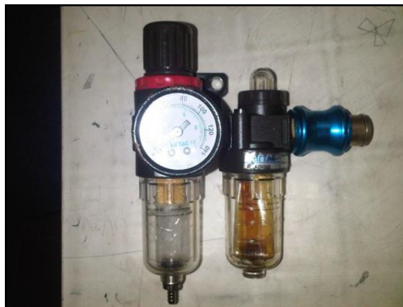
Imagen 22. Unidad de mantenimiento vista de frente
