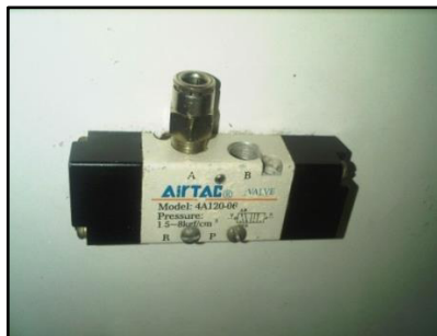
Imagen 4. Válvula 5/2 accionada neumáticamente por ambos lados 1
