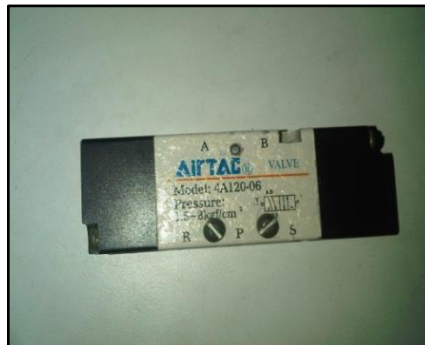
Imagen 7. Válvula 5/2 accionada neumáticamente por ambos lados 3
