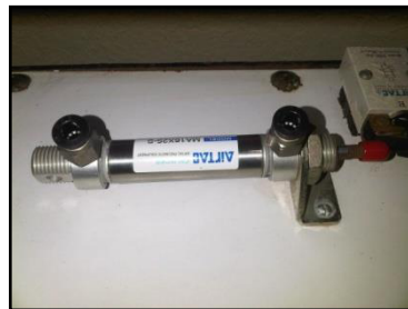
Imagen 29. Cilindro doble efecto 4
