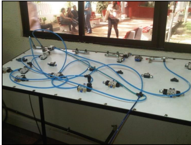
Imagen 75. Montaje del circuito neumático, vista 1.
