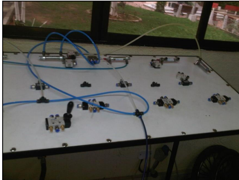
Imagen 74. Montaje del circuito neumático, vista 4.
