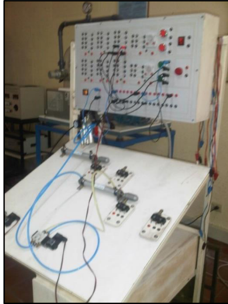
Imagen 83. Montaje del circuito electroneumático, vista 3.
