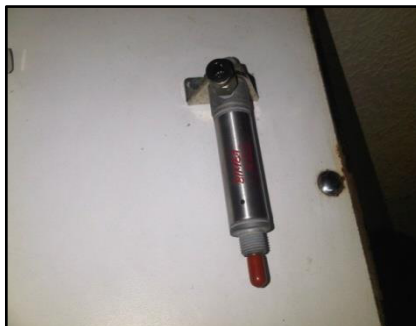
Imagen 24. Cilindro simple efecto 1
