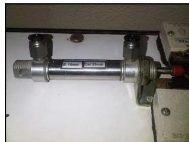
Imagen 27. Cilindro doble efecto 2
