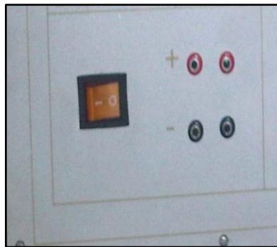
Imagen 15. Switch de encendido del tablero
