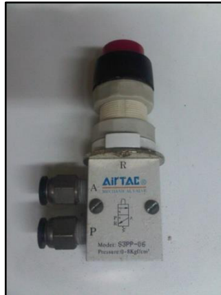
Imagen 30. Válvula 3/2 accionada por pulsador y retorno por muelle.
