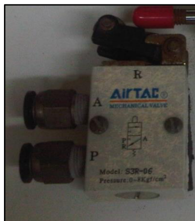
Imagen 31. Válvula 3/2 accionada por rodillo y retorno por muelle
