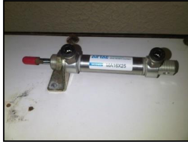
Imagen 28. Cilindro doble efecto 3
