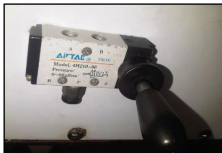
Imagen 6. Válvula 5/2 accionada por palanca enclavable
