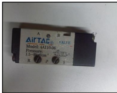
Imagen 3. Válvula 5/2 accionada neumáticamente y retorno por muelle 3
