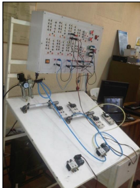
Imagen 82. Montaje del circuito electroneumático, vista 2.
