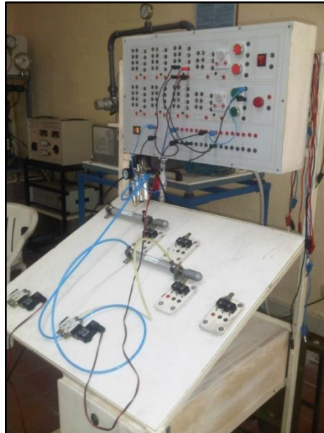
Imagen 80. Montaje del circuito electroneumático, vista 3.
