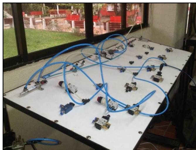
Imagen 71. Montaje del circuito neumático, vista 1.
