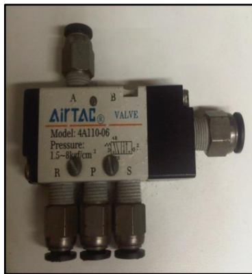
Imagen 11. Válvula 5/2 accionada neumáticamente y retorno por muelle
