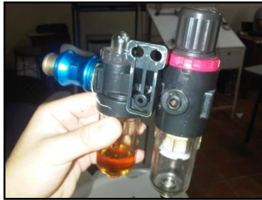
Imagen 23. Unidad de mantenimiento vista lateral
