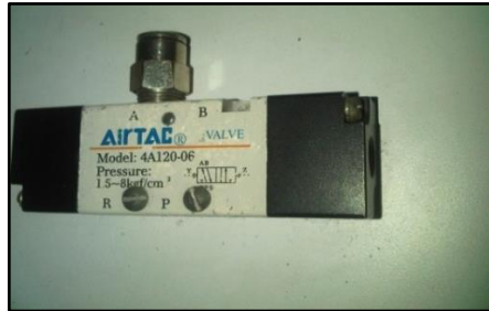
Imagen 5. Válvula 5/2 accionada neumáticamente por ambos lados 2
