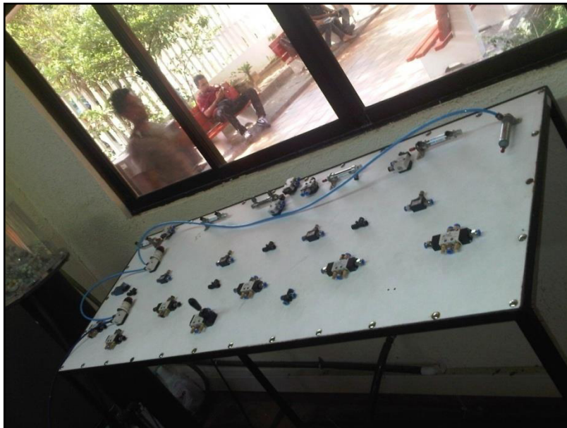
Imagen 53. Montaje del circuito neumático, vista 3.
