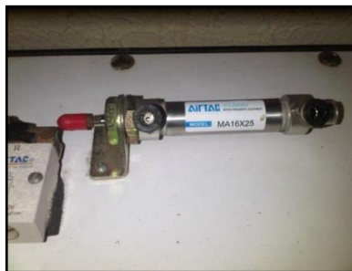
Imagen 26. Cilindro doble efecto 1
