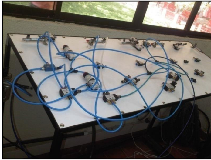
Imagen 54. Montaje del circuito neumático, vista 1.
