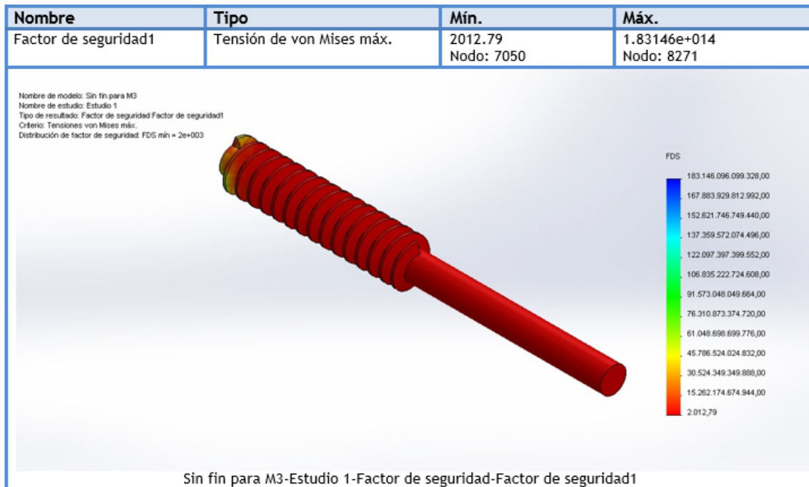
Figura 25. Resultado del estudio del factor de seguridad en el tornillo sin fin.
