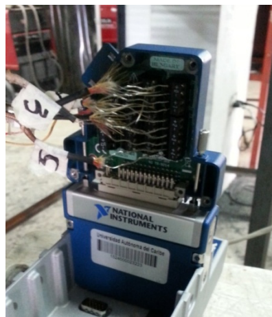
Figura 30. Montaje de termopares en el ADQ
