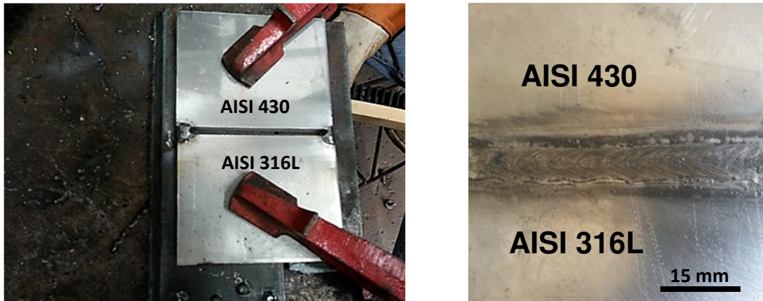
Figura 21. Placas de Aceros AISI 430 Y AISI 316L preparadas para ser soldadas
