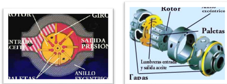
Figura 1: Esquema y despiece del interior de una bomba hidráulica
