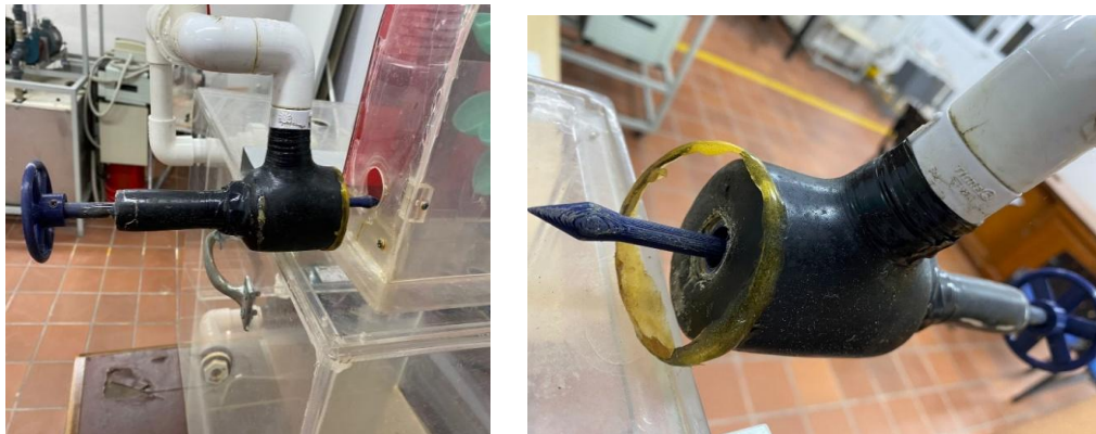
Figura 5: Inyector de turbina Pelton, banco de prueba
