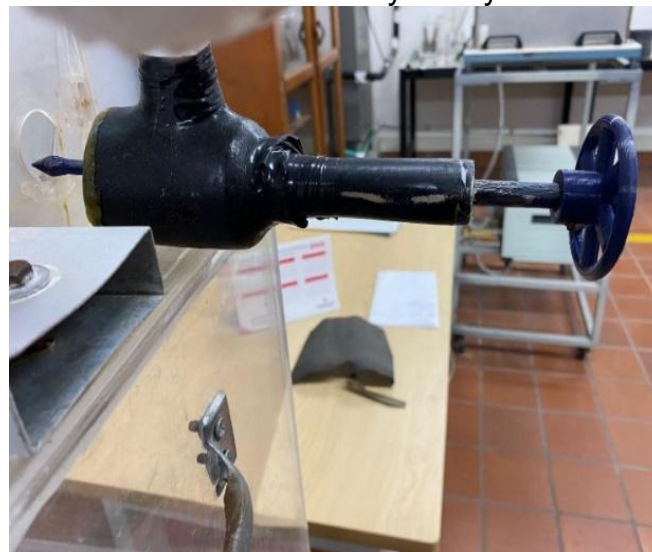
Figura 4: Inyector con fugas, propia autoría
